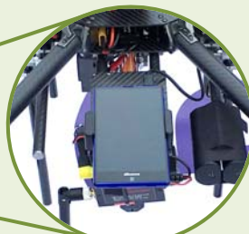
ドローンに搭載したスマートフォン
